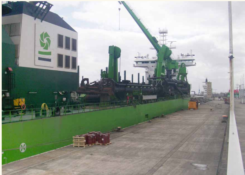
Großbagger „Bonny River“ bei Arbeitspause an der Seebäderbrücke: 6 Stockwerke hoch, 120 Meter lang, 10.000 Kubikmeter Fassungsvermögen. Foto: privat, 14.4.2020
